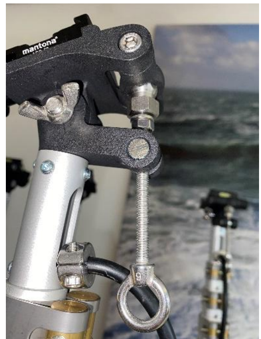
Schraube zum Verstellen des Neigungswinkels
